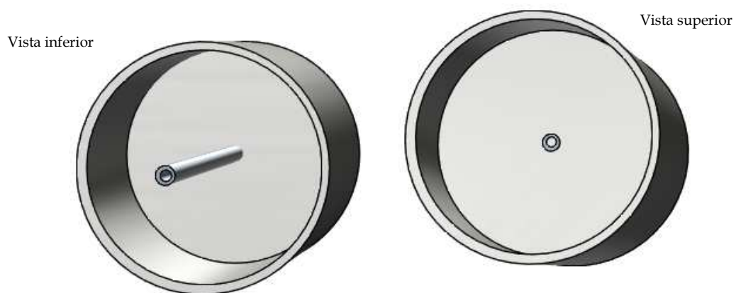
Figura 18. Cámara de captación.
